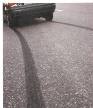
圖 6.3g 汽車緊急剎停時，輪胎的橡膠變熱，在路面留下剎車痕
