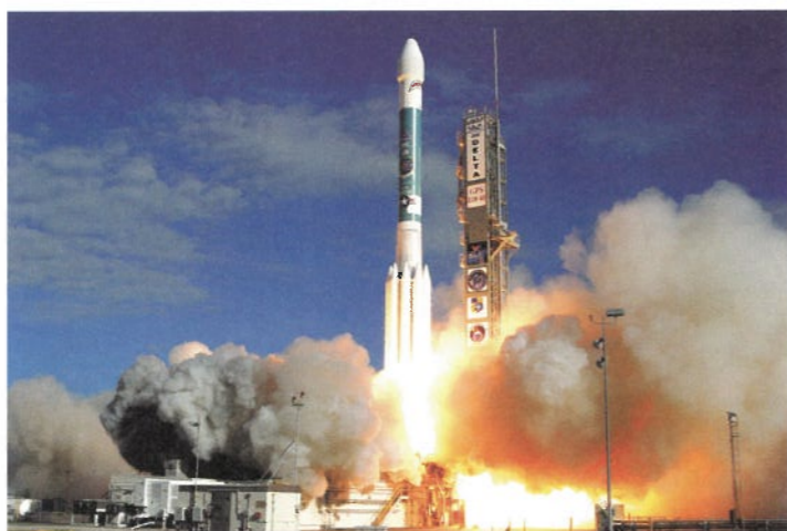
圖 3.5a 火箭將氣體推向下，氣體則將火箭推向上。
