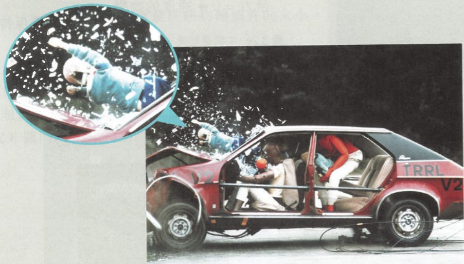
圖 a 撞擊測試顯示汽車猛烈撞上障礙物時，乘客會衝向前方，甚至拋出車外
