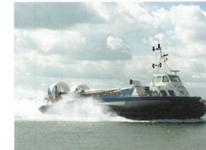
(iii) 氣墊隔開船身和水面
