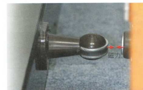
圖 3.1k 兩顆磁石相隔一段距離，但我們仍能感受到它們之間的吸力
