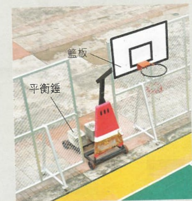
平衡錘既降低籃球架的重心，它的力矩又可抵銷籃板的力矩
