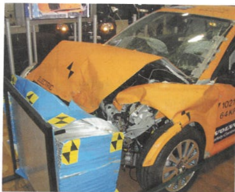
(i) 汽車頭尾兩部分（變形區域）都可摺疊變形，以延長撞車時的撞擊時間
