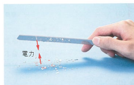
圖 3.1j 帶電膠尺沒有接觸紙碎，卻可將它們吸起
