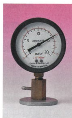
圖 5.1f 布爾登氣壓計及它的結構
