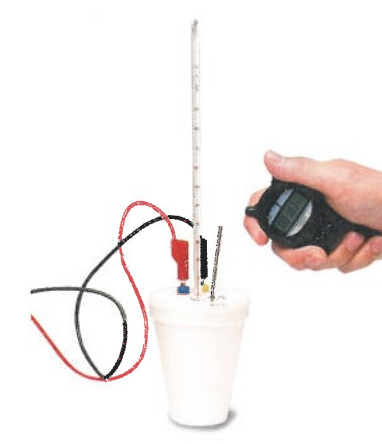
圖 j 量度水的比熱容量 (c)
