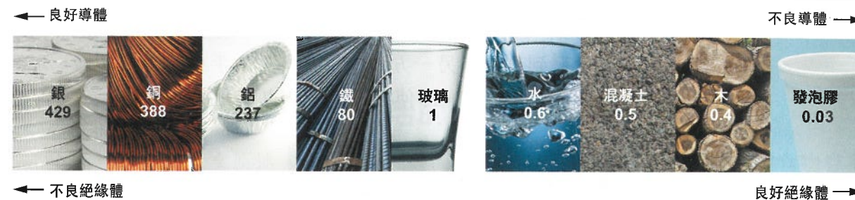
圖 4.1d 比較不同物質的導熱能力（與玻璃相比）
