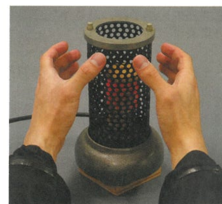
圖 4.3b 感受由電暖爐發射的輻射
