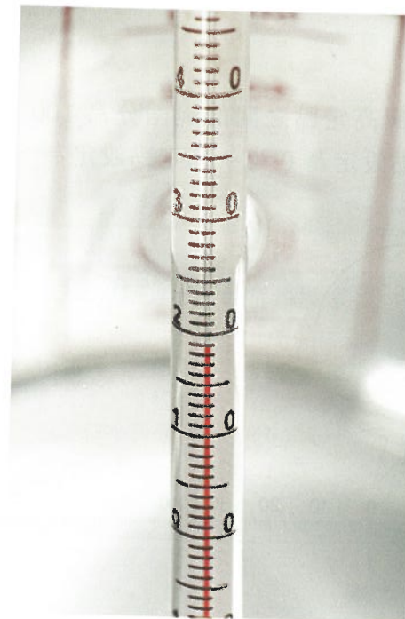
圖 1.1c 溫度計上的溫標
