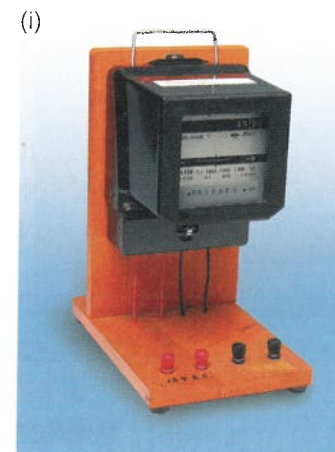
圖 2.1g (i) 焦耳計和 (ii) 千瓦時計
