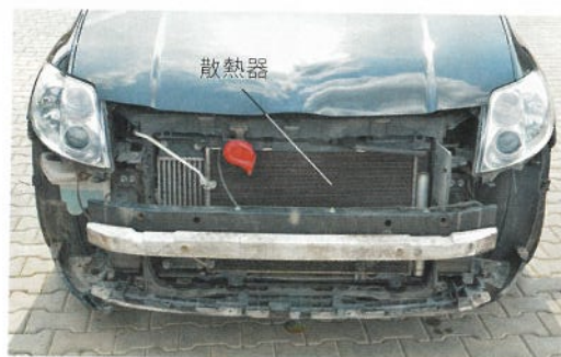
圖 4.3f 汽車的散熱器是黑色的，能更有效地散熱
