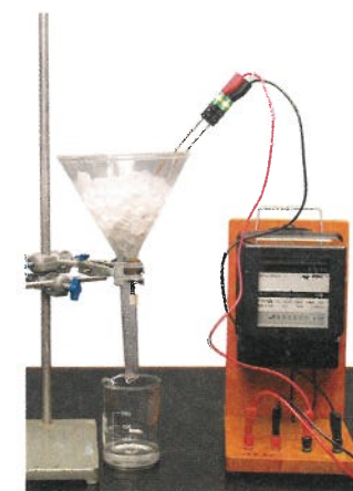
圖 i 量度冰的熔解比潛熱 ( l_f )
