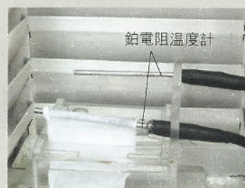
保護罩內的鉑電阻溫度計
