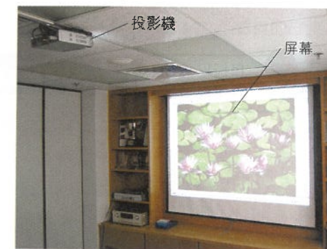
圖 3.2f LCD 投影機投射的是實像
