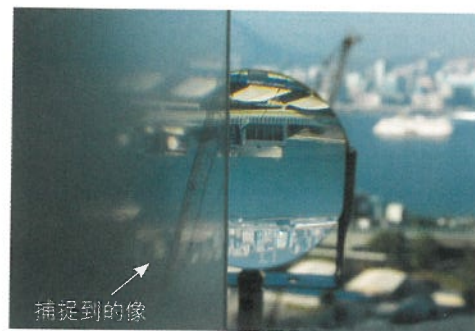
圖 3.2k 來自遙遠物體的平行光線聚焦在焦平面上
