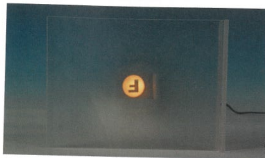
圖 3.2a 用屏幕捕捉字母「F」的像
