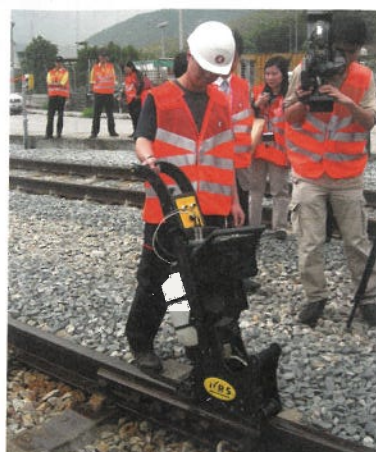
圖 7.3d 超聲波在固體中遇到裂紋時會反射，因此可用作檢查鐵路軌道
