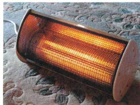
(i) 輻射式暖爐直接照射物體來加熱，減少熱傳遞到周圍的空氣
