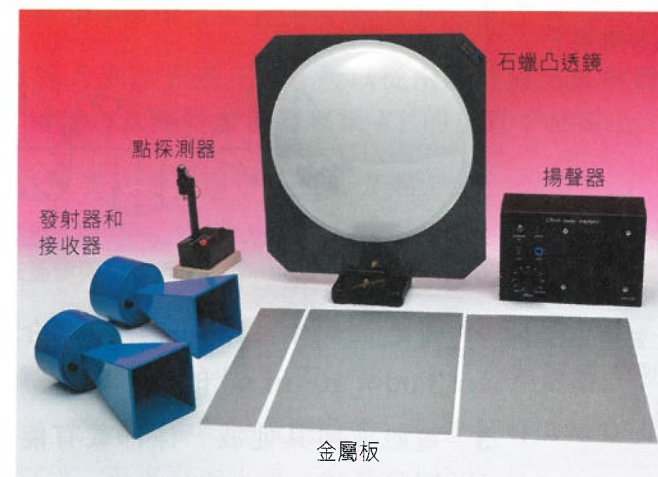
圖 6.3d 3 cm 微波發射和接收裝置
