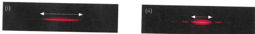
圖 6.1f (i) 較窄的狹縫和 (ii) 較闊的狹縫產生的衍射圖形
