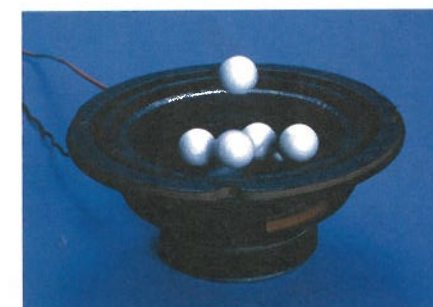
圖 7.2a 揚聲器的紙盆振動，使發泡膠球上下彈跳
