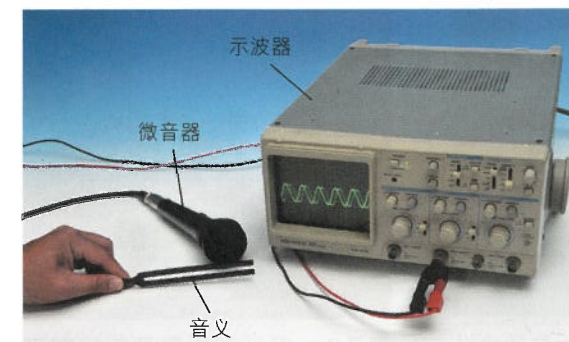
圖 7.2j 利用微音器和示波器探測聲音
