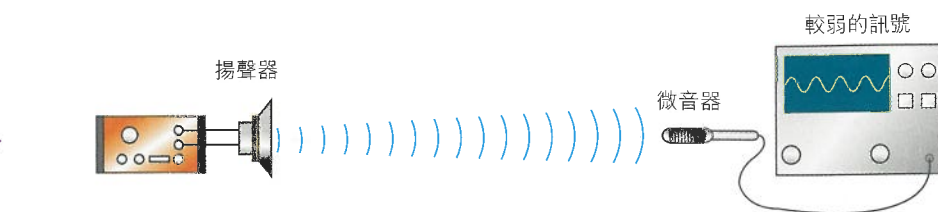
(i) 微音器探測揚聲器發出的聲音
