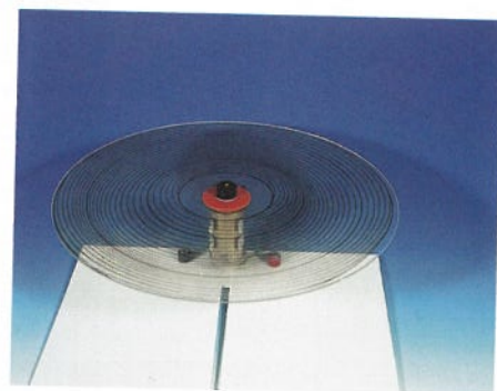
圖 7.1b 縱波模型包含一個透明圓盤，圓盤上面畫有一組特別的圓形條紋
