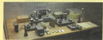
哈恩研究團隊發現核裂變時所用的實驗裝置
