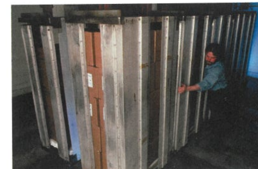
圖 2.3f 醫療用具放置好後，經 \gamma 射線照射來消毒
