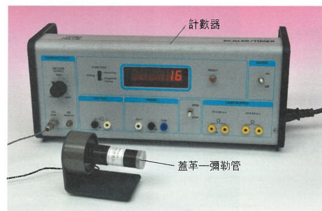
圖 1.21 蓋革—彌勒計數器由蓋革—彌勒管和計數器連接而成
