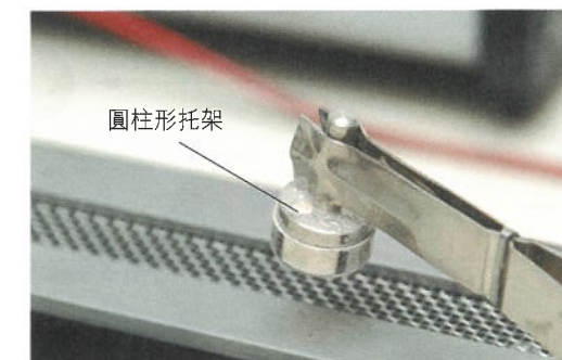
圖 1.2b 學校實驗室使用的放射源鑲在圓柱形的金屬托架內
