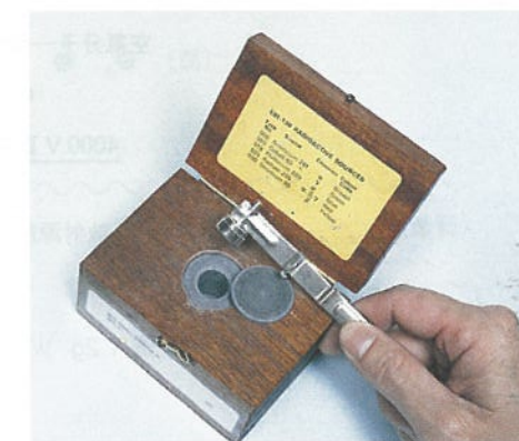
圖 1.2d 用專用工具拿取放射源
