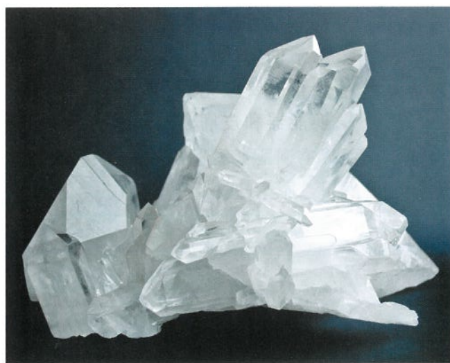
圖 2.2h 石英是一種壓電晶體，常用於計時器中
