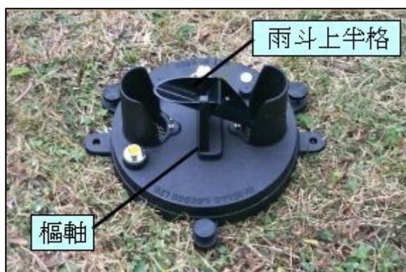
翻斗式雨量器常應用於自動氣象站來量度雨量。這種雨量器的分格式雨斗組件，採用蹺蹺板的原理。樞軸置於中央，當雨斗上半格所收集的雨水達到預設的雨量時，雨斗便會傾斜，把收集所得的雨水排走，並移動雨斗上另一邊半格於集雨口準備收集雨水。與此同時，雨斗翻動產生電流脈沖並由數據記錄儀記錄，把選定時段內的數據相加，便可得出其間雨量的總和。雨斗在收集到 0.5 毫米（天文台雨斗每次收集 0.1 毫米）的累積降雨量後，便會傾斜翻動一次。
