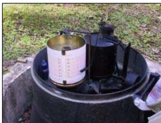
當雨量達到 25 毫米，虹吸式雨量器最大容量，雨量器會自動排水。雨量記錄便由零開始。
