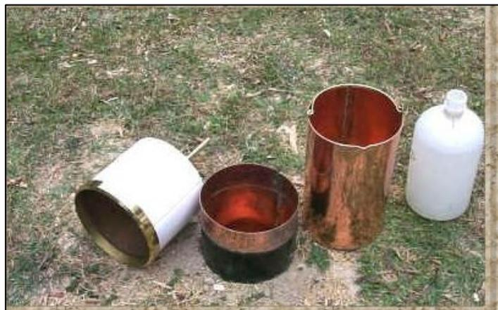
普通雨量器專供有觀測員的氣象站使用。雨水經漏斗收集於集雨罐內。天文台總部所用的雨量器，直徑為 203 毫米。把收集到的雨水倒進量筒內，便可量度雨量。
